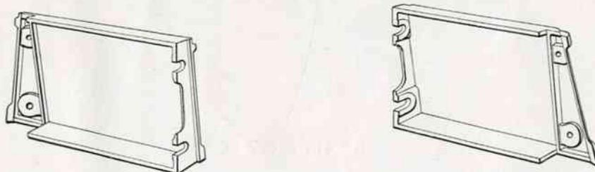
Plaques de soubassement d'un générateur cylindrique à Magasin de Combustible.
